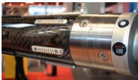
Eine pneumatisch betätigte Wickelwellen aus Kohlefaser-Verbundwerkstoff (CFK) mit integriertem RFID-Tag und CMS-Sensor
